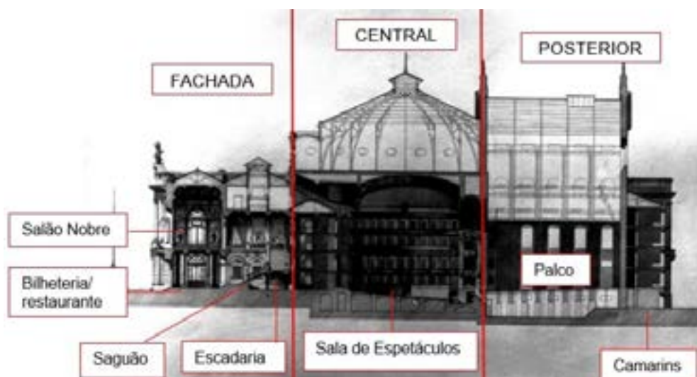
Figura 1. Corte longitudinal do projeto original do TMSp, no qual se identificam seus principais ambientes. Acervo de fontes iconográficas da biblioteca da FAU-USP
