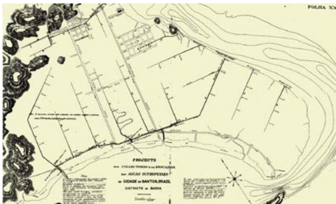
Figura 4. Projeto dos coletores de águas pluviais do plano elaborado por Estevan Fuertes. São Paulo, 1895.
